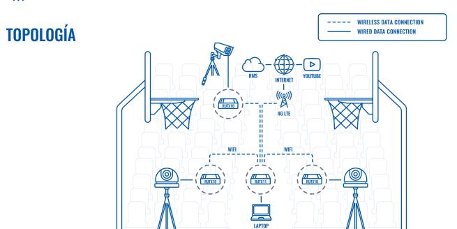
Utilizamos los routers inalámbricos RUTX10 para conectarlos en una red inalámbrica y enviamos todas las transmisiones a un ordenador portátil. Utilizamos el router RUTX11 LTE Cat 6 para transmitir directamente a Youtube. La carga fue rápida y sin problemas, alcanzando velocidades de hasta 50 Mbps.
